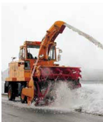
ロータリー除雪車／豪雪地帯の魚沼では、神業を持つ作業員が多い。
