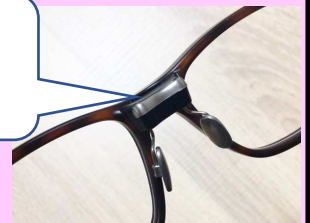
電極が3個あり、これが鼻に当たることで生体データを取得できます。
